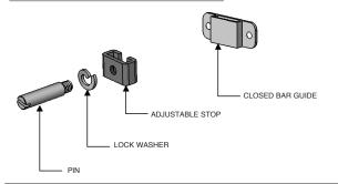
CAM LOCK GLASS INSTALLATION PACKAGE
